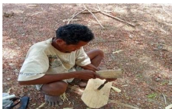
Gambar 1.7 Proses Pembuatan Lubang Resonansi (meup usan) Sumber: Dokumentasi Peneliti, Desember 2023
